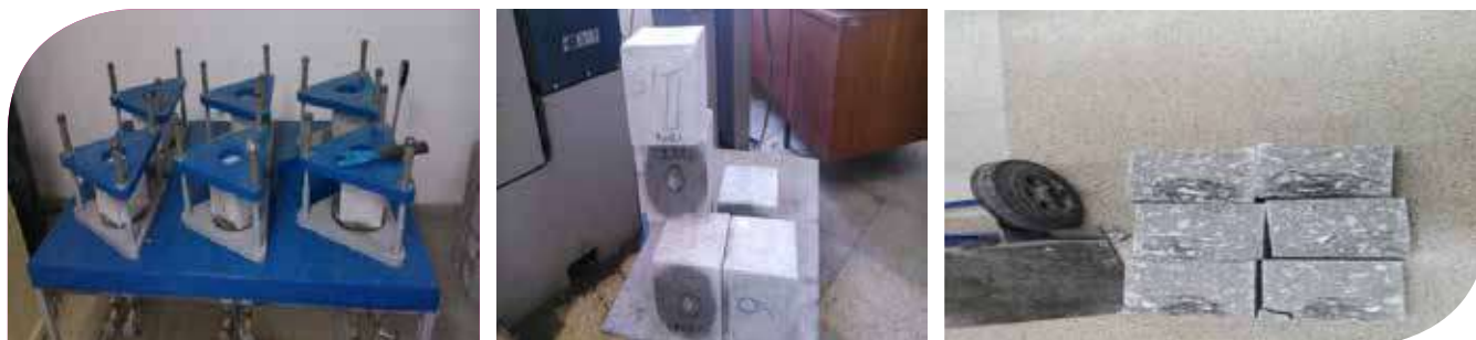
Ispitivanje otpornosti betona na prodor vode pod pritiskom
