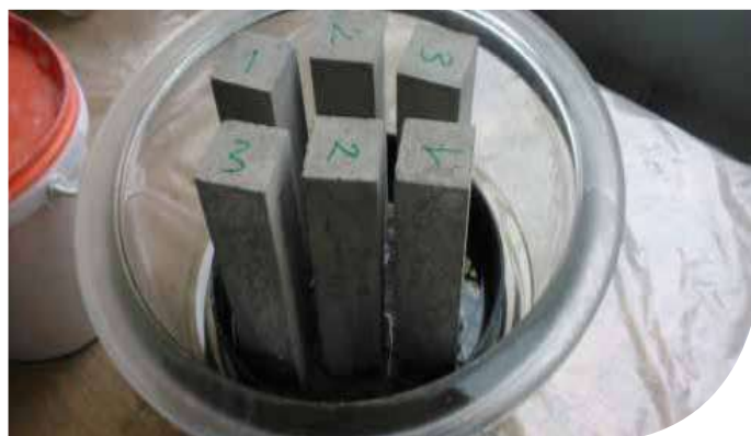
Ispitivanje otpornosti maltera na kapilarnu apsorpciju
