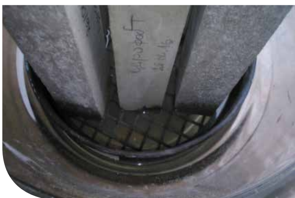
Ispitivanje otpornosti maltera na kapilarnu apsorpciju
