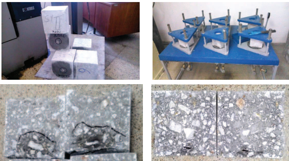
Ispitivanje otpornosti betona na prodor vode pod pritiskom
