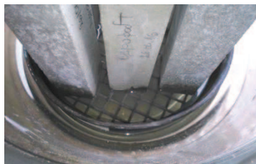
Ispitivanje otpornosti betona na kapilarnu apsorpciju
