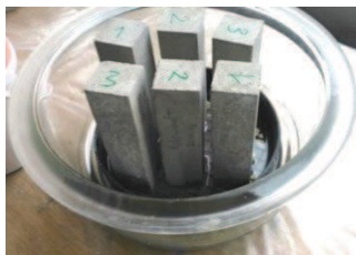
Ispitivanje otpornosti betona na kapilarnu apsorpciju
